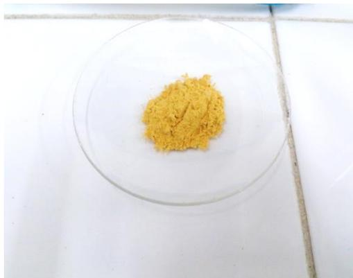
**Figure III- 4 : Echantillon tamisé à  $dp \leq 100\mu\text{m}$ .**
