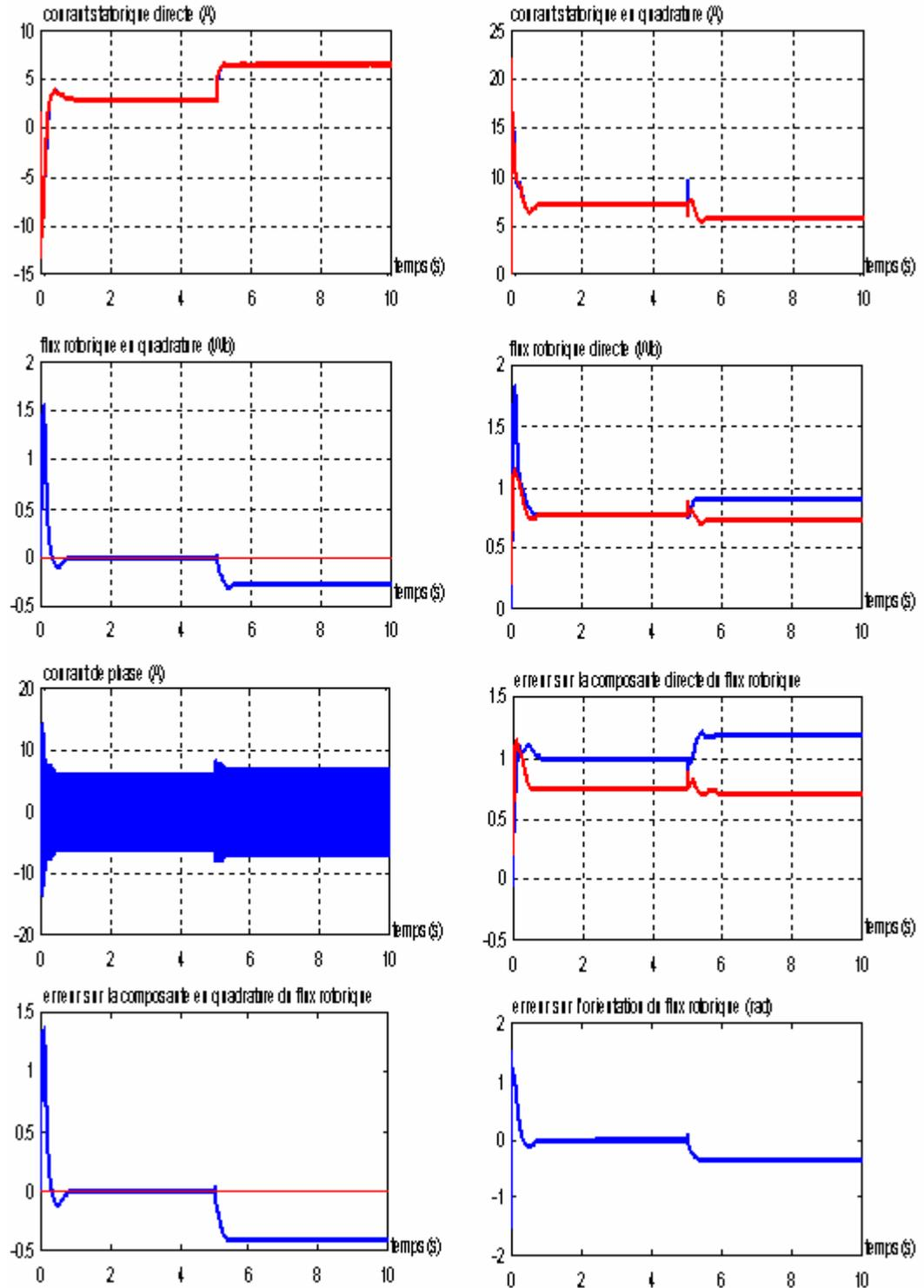
Figure 4.44 Résultats de simulation de la commande optimale en régime permanent pour un démarrage à pleine charge et pour  $L_m = 0.8L_m^*$
