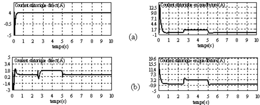
Figure 4.9 Comparaisons des courants direct et en quadrature pour un démarrage à vide et application d'une charge de 2.5Nm.
