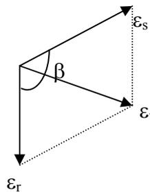
Figure 1.1 Représentation des forces magnétomotrices dans le plan complexe
