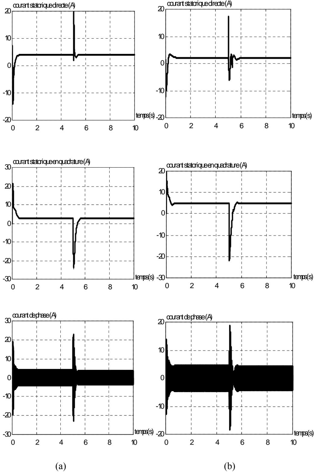
Figure 4.33 Démarrage à 50% de la charge nominale avec inversion de vitesse à  $t=5s$
