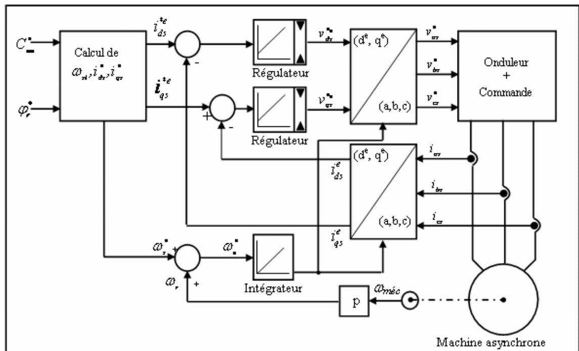
Figure 3.3 Schéma de principe de l'orientation du flux rotorique
