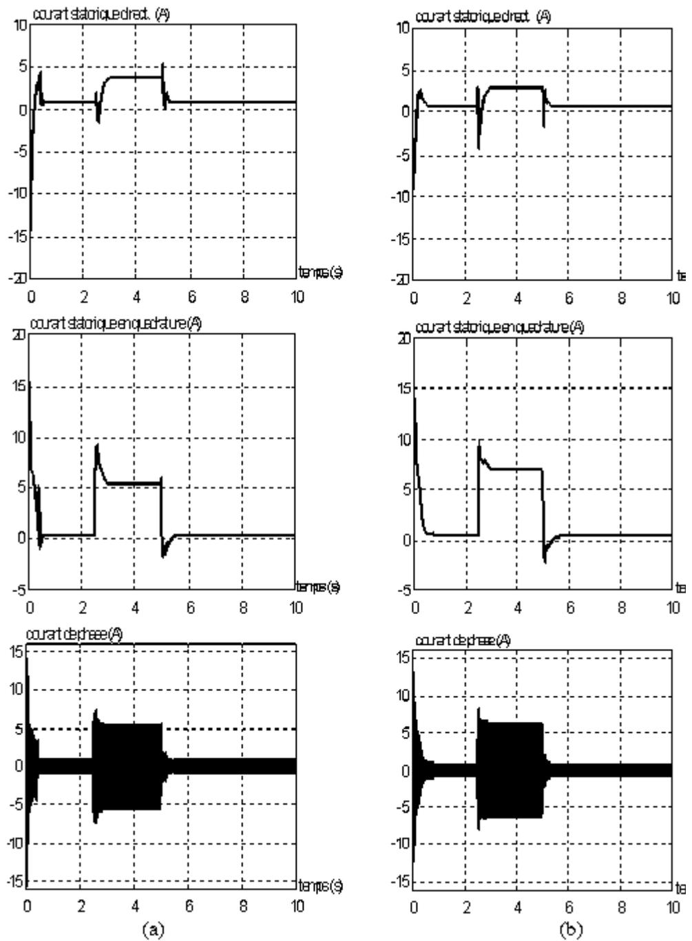
Figure 4.38 Démarrage à vide avec application d'un couple de charge de 10 Nm à  $t=2.5s$ .
