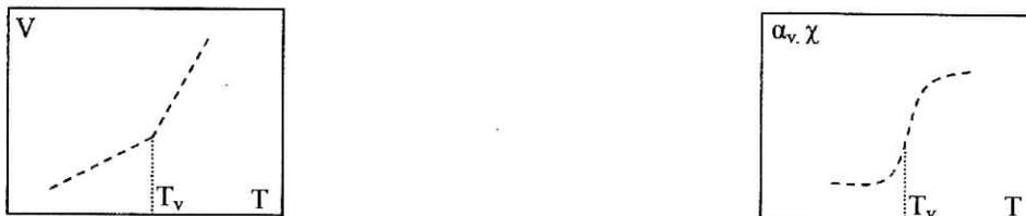
Fig.3-2 : Variation des propriétés thermodynamiques  $V$ ,  $\alpha_v$  et  $\chi$  de part et d'autre de  $T_v$
