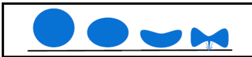
Figure II. 10 Implosion des bulles de cavitation près d'une paroi solide (Michel T., 2011)
