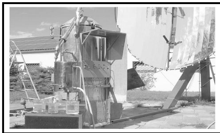
Figure II. 12 Photo de l'installation d'hydrodistillation solaire (Munir & al, 2010)
