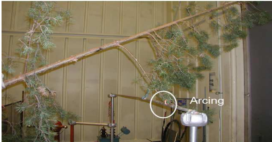
Figure I.27 : Mode expérimental pour initier l'arc
