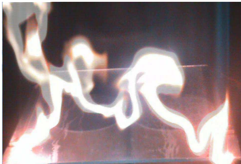
Figure IV.6: contournement entre les électrodes
