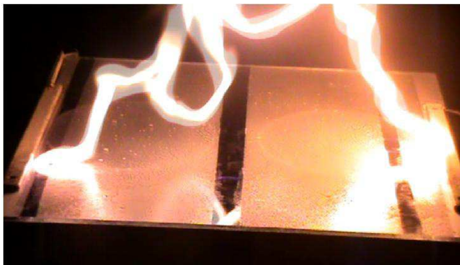
Figure V.5: Contournement entre les électrodes
