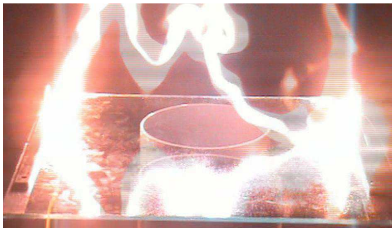
Figure IV.8: Contournement entre les électrodes
