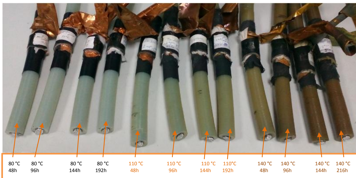
Figure IV.9.b : Tronçons de câble complet 18/30 isolés par le PRC après vieillissement thermique
