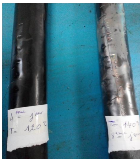
Fig. IV.10 : Tronçons de câble complet avec la gaine du PVC après vieillissement thermique
