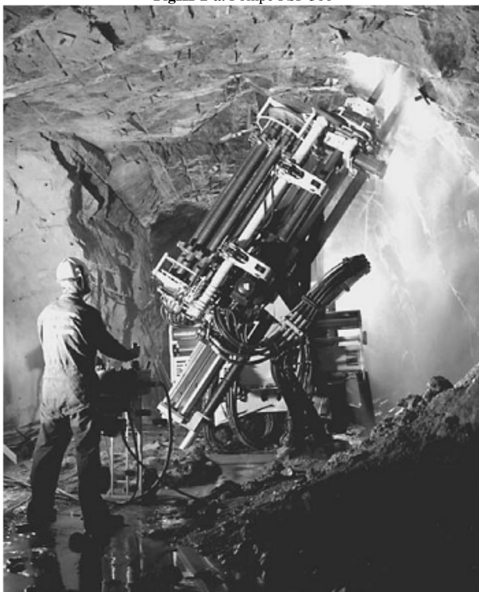
**FigureIII-2-b.**Engin de foration des trous de mine. [11]
