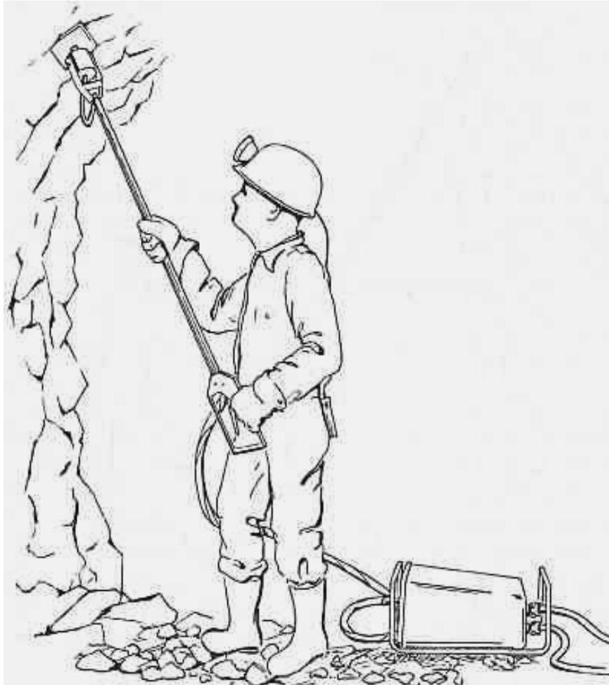
**FigIII-5.** Mise en place d'un boulon Swellex.
