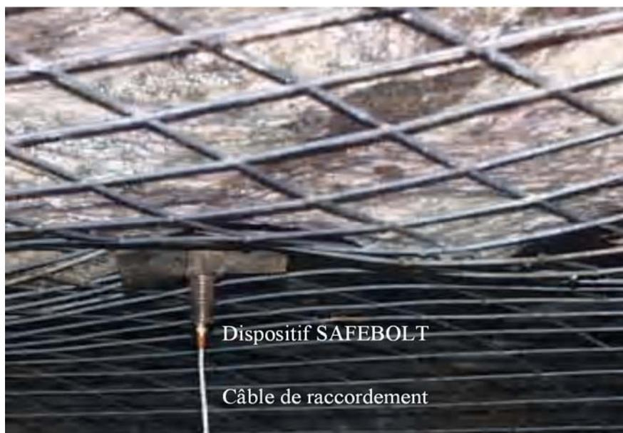
**FigIII-15.** Mesure des charges axiales dans la mine à l'aide du système SAFEBOLT.
