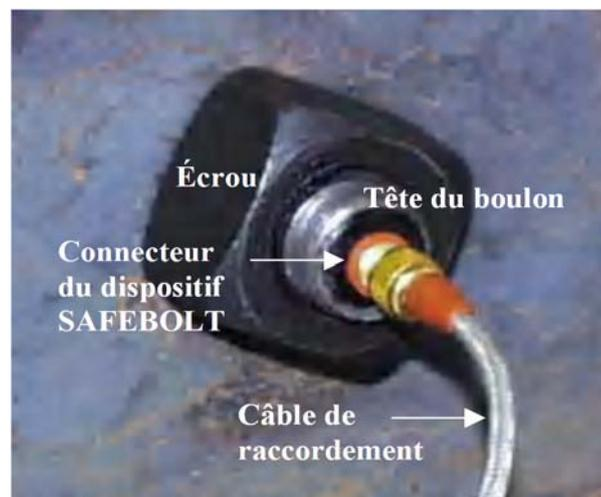
**FigIII-13.** Dispositif SAFEBOLT enchâssé dans la tête du boulon et raccordé au câble.
