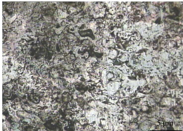
Figure IV.21. Micrographie de l'échantillon après 7 jours d'immersion dans l'eau de gisement sans décapage (Gr x 100).
