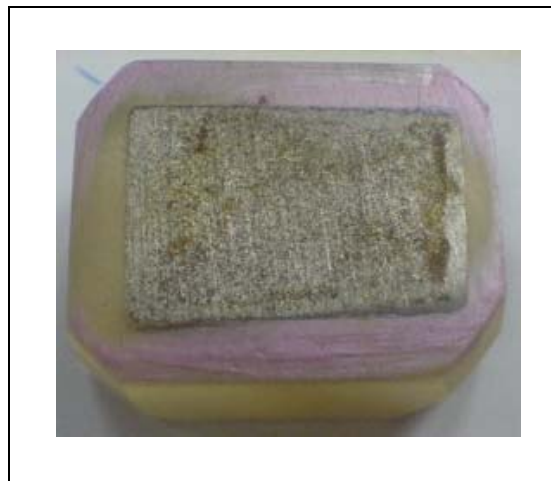
Figure IV.23. Une photo prise après test d'immersion pendant 7 jours dans l'eau de gisement.
