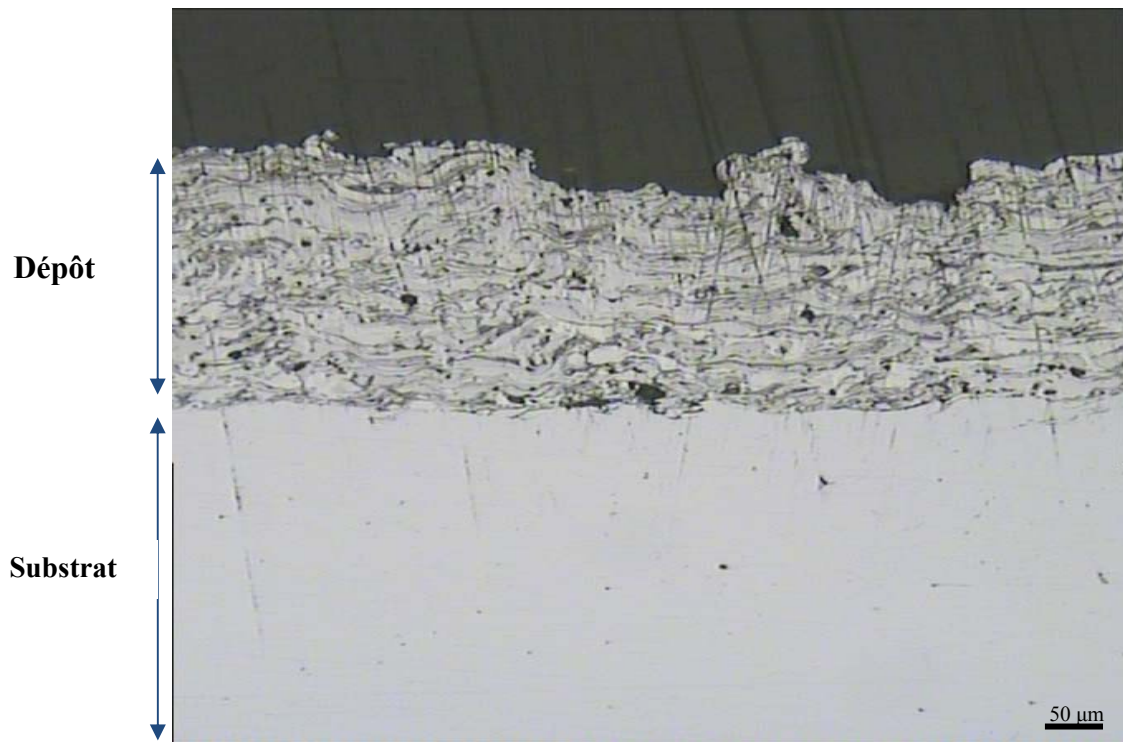
Figure IV.2. Micrographie interfaciales du dépôt 80E réalisé par projection thermique sur l'acier au carbone API 5L X65 (Gr x10).
