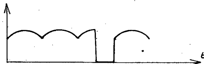
Courant d'entrée de l'onduleur.
