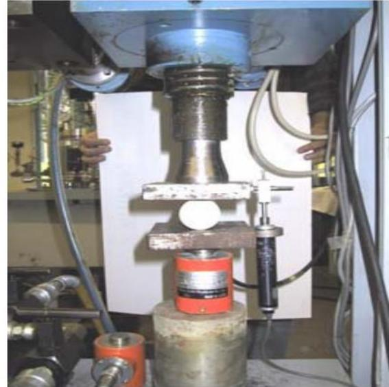
Figure II-11 : Essai brésilien
