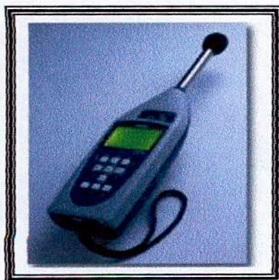
Schéma 1.1 : Sonomètre ancien modèle
