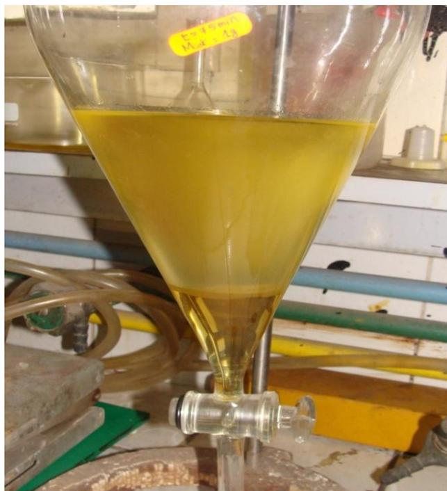
**Figure IV.3** : les deux phases de biodiesel et glycérol
