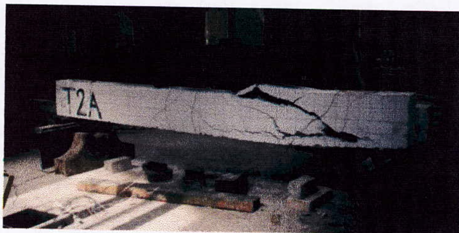
Photo 12 : Poutre T2A après rupture
