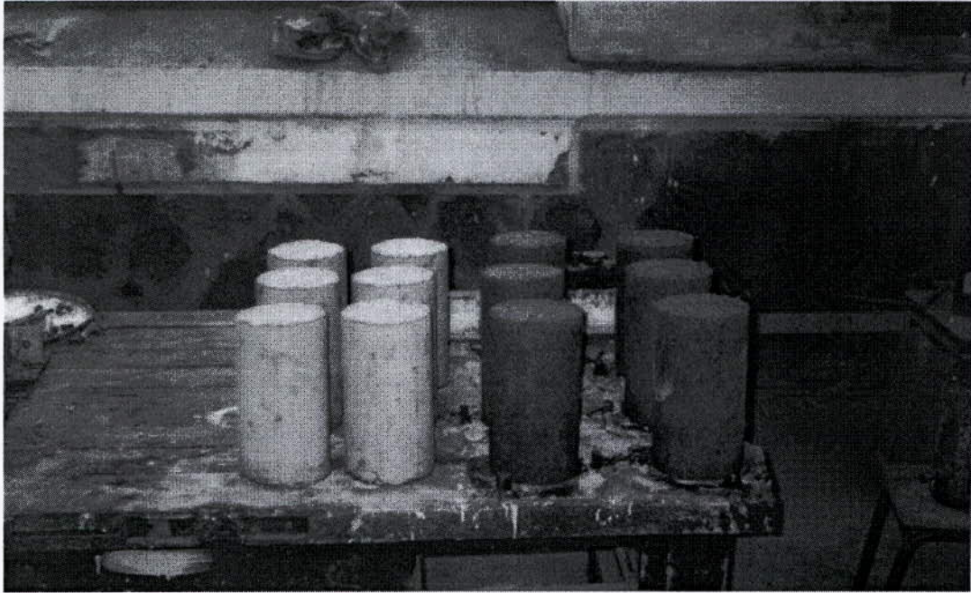
Photo – 7 – A gauche les éprouvettes cylindriques de béton blanc A droite les éprouvettes cylindriques de béton de fibres
