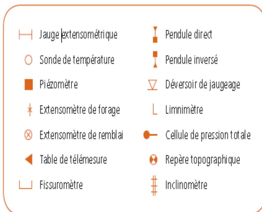
**Figure. I.2 :** Légende des appareillages d'auscultation utilisés dans les barrages
