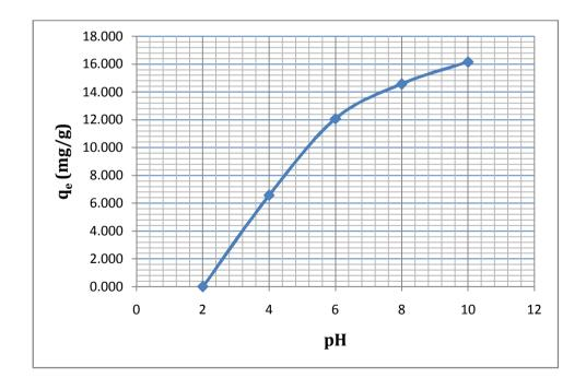
**Figure VI.16.** Influence du pH dans le cas de l'adsorption des ions Mn<sup>2+</sup> en mélange sur la biomasse *Pleurotus Mutilus*
