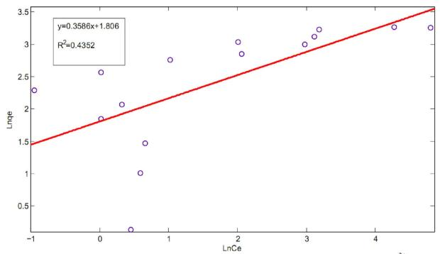
**Figure VI.26.** Application du modèle de *Freundlich* dans le cas d'adsorption du Fe<sup>3+</sup> en mélange sur la biomasse *Pleurotus Mutilus*.
