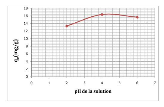
**Figure VI.13.** Influence du pH dans le cas de l'adsorption des ions Fe<sup>3+</sup> sur la biomasse *Pleurotus Mutilus*.
