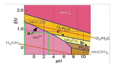
**Figure I.2.** Formes de manganèse en fonction de pH et du potentiel.
