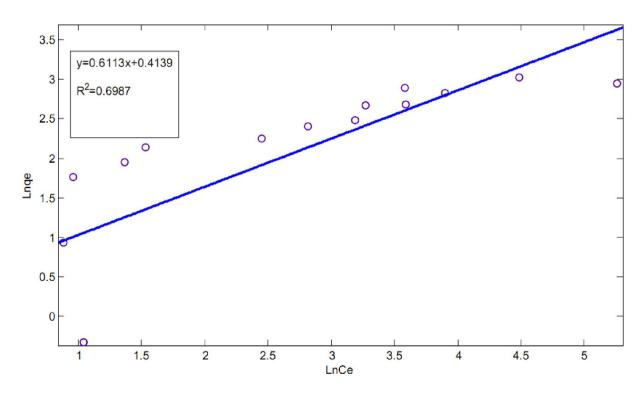
**Figure VI.25.** Application du modèle de *Freundlich* dans le cas d'adsorption du Mn<sup>2+</sup> sur la biomasse *Pleurotus Mutilus*.
