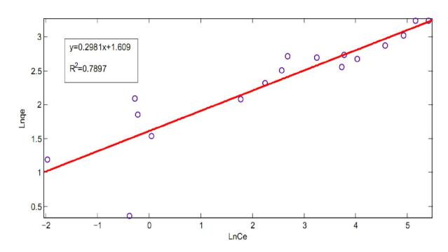
**Figure VI.24.** Application du modèle de *Freundlich* dans le cas d'adsorption du Fe<sup>3+</sup> sur la biomasse *Pleurotus Mutilus*.
