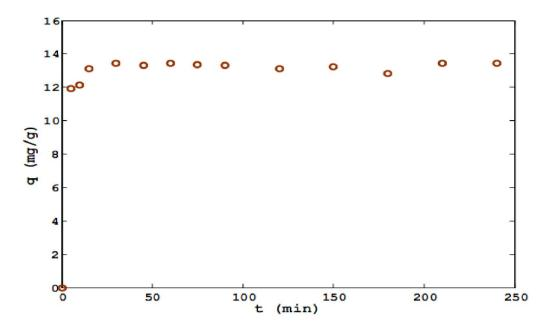
**Figure VI.3 :** Etude cinétique de la biosorption des ions Fe<sup>3+</sup> en mélange sur la biomasse *Pleurotus Mutilus*.
