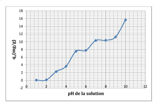
**Figure VI.14.** Influence du pH dans le cas de l'adsorption des ions Mn<sup>2+</sup> sur la biomasse *Pleurotus Mutilus*
