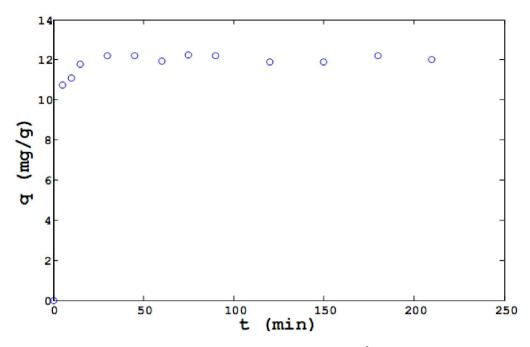
**Figure VI.2 :** Etude cinétique de la biosorption des ions  $Fe^{3+}$  sur la biomasse *Pleurotus Mutilus*.
