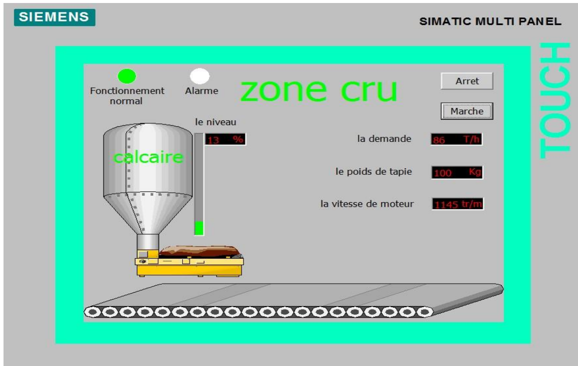
Figure 36: Exécution du programme de simulation Le système 'Runtime'.
