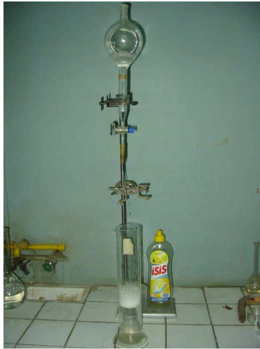
Fig.9 : Représentation schématique de l'appareil de mesure du pouvoir moussant.
