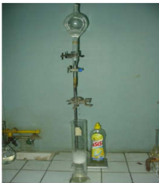
Fig.12 : Représentation schématique de l'appareil de mesure du pouvoir moussant
