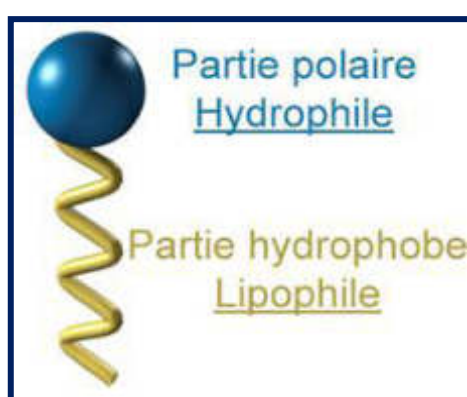
Fig.1 : Représentation schématique d'une molécule de tensioactif
