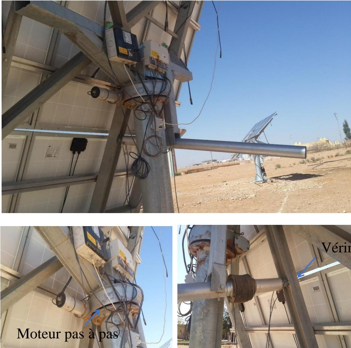
Figure 0.3. Système de mouvement à moteur pas à pas et vérin électrique.
