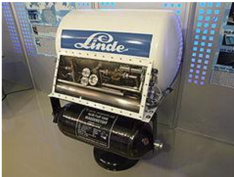
Figure 1.5 : Réservoir d'hydrogène liquide de Linde, Museum Autovision, Altlußheim, Germany
