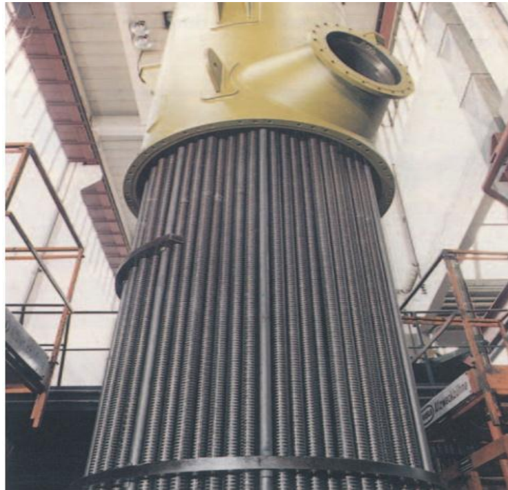
Fig.6 : Montage d'un échangeur thermique pour la concentration d'acide phosphorique (exemple d'application typique des tubes en DIABON HF1 renforcé fibres de carbone).
