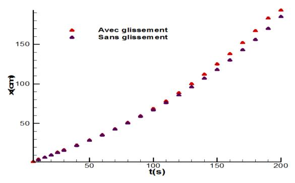
Fig.10: Propagation du front du courant de densité en fonction du temps, dans les deux cas : avec ou sans glissement.
