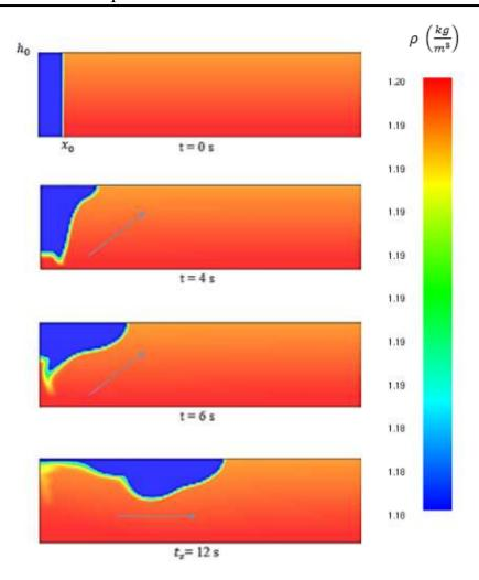
Fig. 3: Simulation FDS, phase de subsidence « Slumping phase », en Boussinesq.
