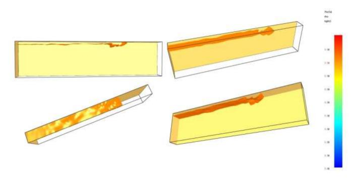
Fig.6: Iso-surface de masse volumique  $\rho = 1.19 \text{ kg/m}^3$  visualisée par Smokview à t = 10 s.
