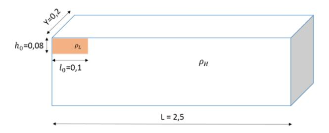
Fig. 7: Modèle géométrique adapté pour les simulations FDS (Unité « m »).
