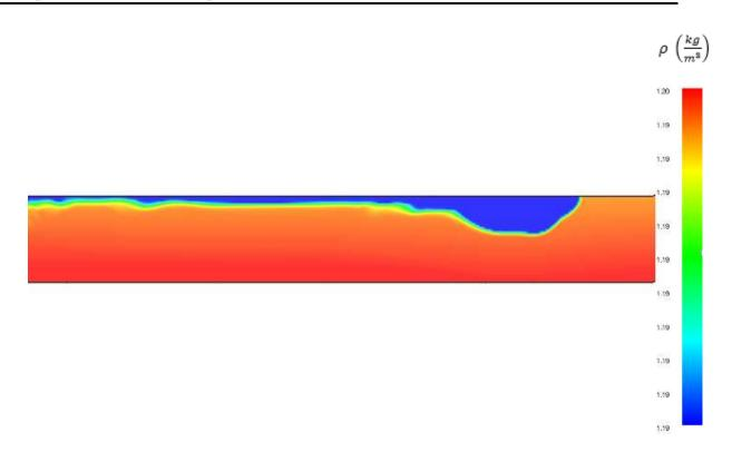
Fig. 4: Illustration faisant apparaître l'importance de la hauteur du front du courant par rapport à sa queue, extraite d'une simulation FDS en Boussinesq à t = 0.5 s
