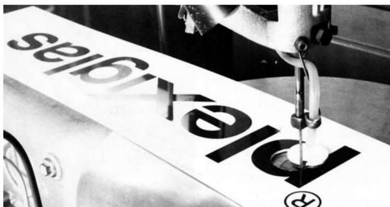
Figure 8 scie à découper pour réaliser une inscription
