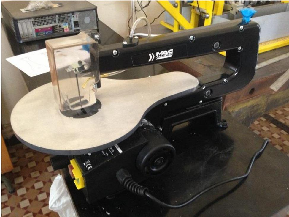
Figure 19 Scie à chantourner
