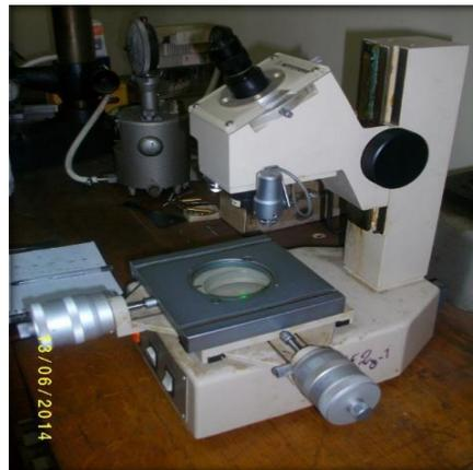
Figure 31 Microscope MITUTOYO pour vérifier les entailles
