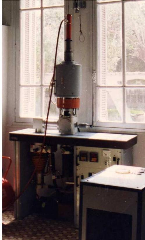
**Figure.6.2.** *Vue générale du dispositif du frittage.*
