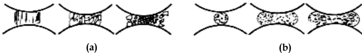
**Figure 1.2.** Effets de l'impact sur les matériaux fragiles (a) et ductiles (b) [20].
