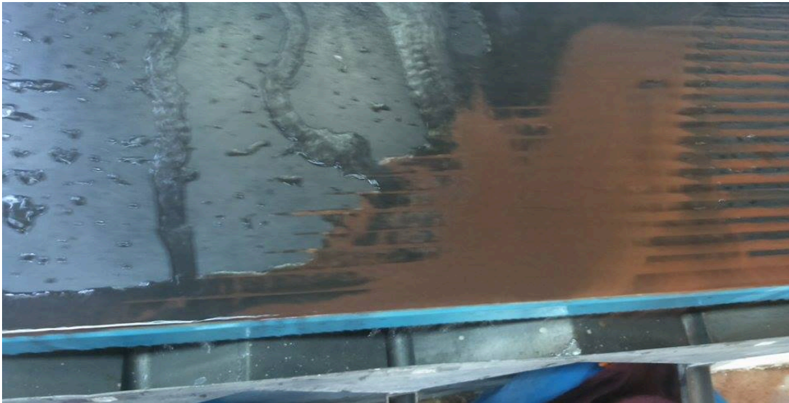
Figure III.9 : séparation par table à secousse (tranche 0,630 – 0,400 mm)
