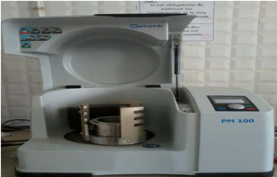
Figure III.10 : Broyeur à billes de type Retsch PM-100
