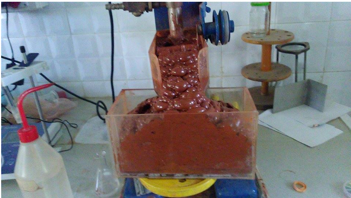
Figure III.12 : Mousse récupérée après l'essai de flottation
