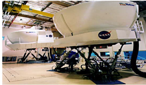
Figure 2.3 – Simulateur de Vol : application de la Plateforme de Stewart
