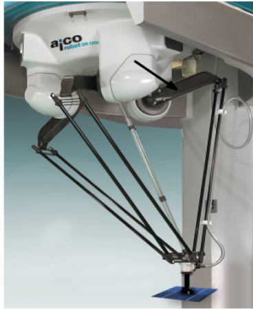
Figure 2.8 – Delta à actionnement rotatif
