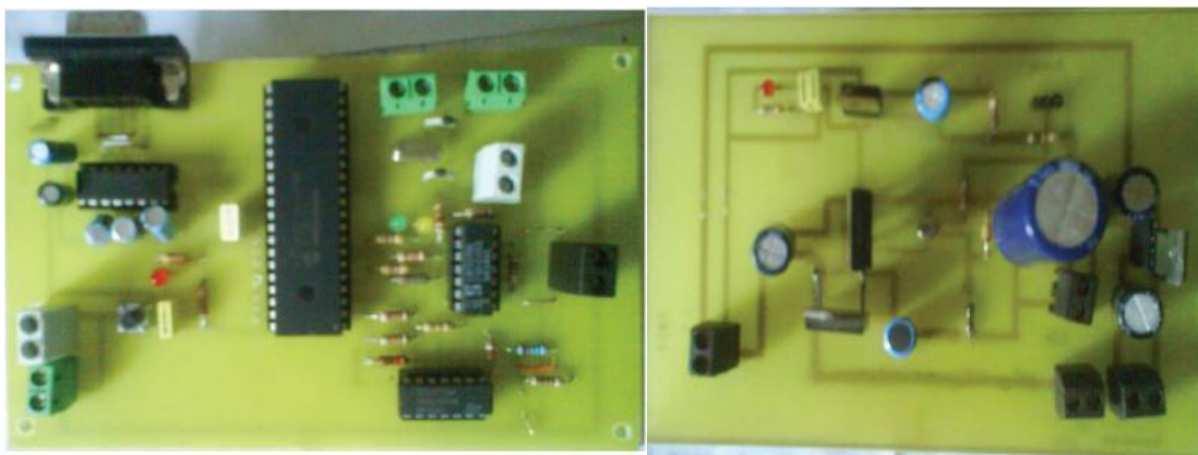
Fig.3.15 : Photo du contrôleur MPPT et du hacheur survolteur réalisés.
