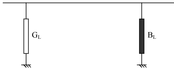
Figure 2.6 Schéma de l'admittance équivalente d'une charge.
