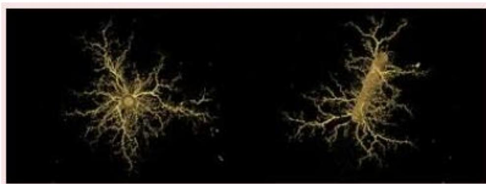
**Figure 0-1 : Formation de wormhole durant le process de la dissolution de la roche carbonatée**
