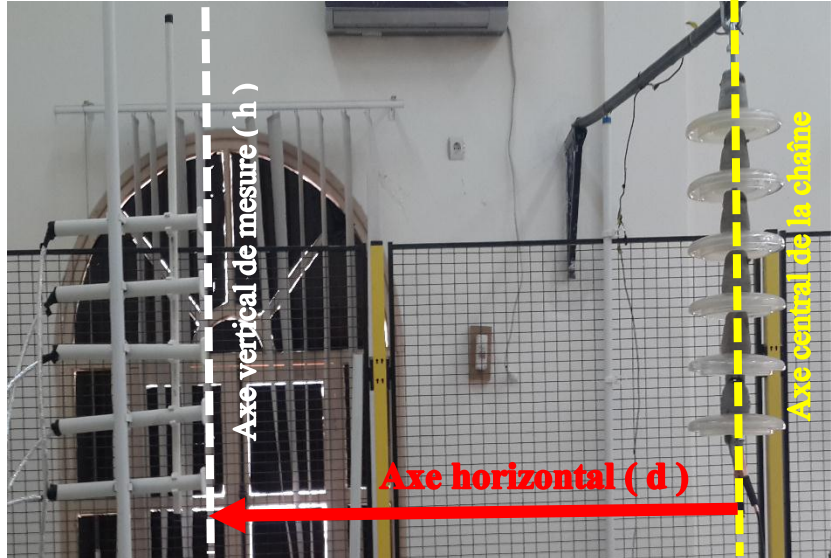
Figure II.3. La chaîne d'isolateurs utilisée et les axes de mesure du champ
