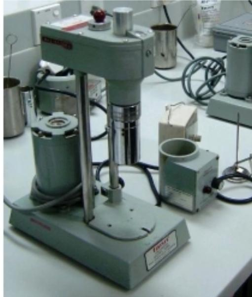
Figure 3.2: Rhéomètre FANN35
