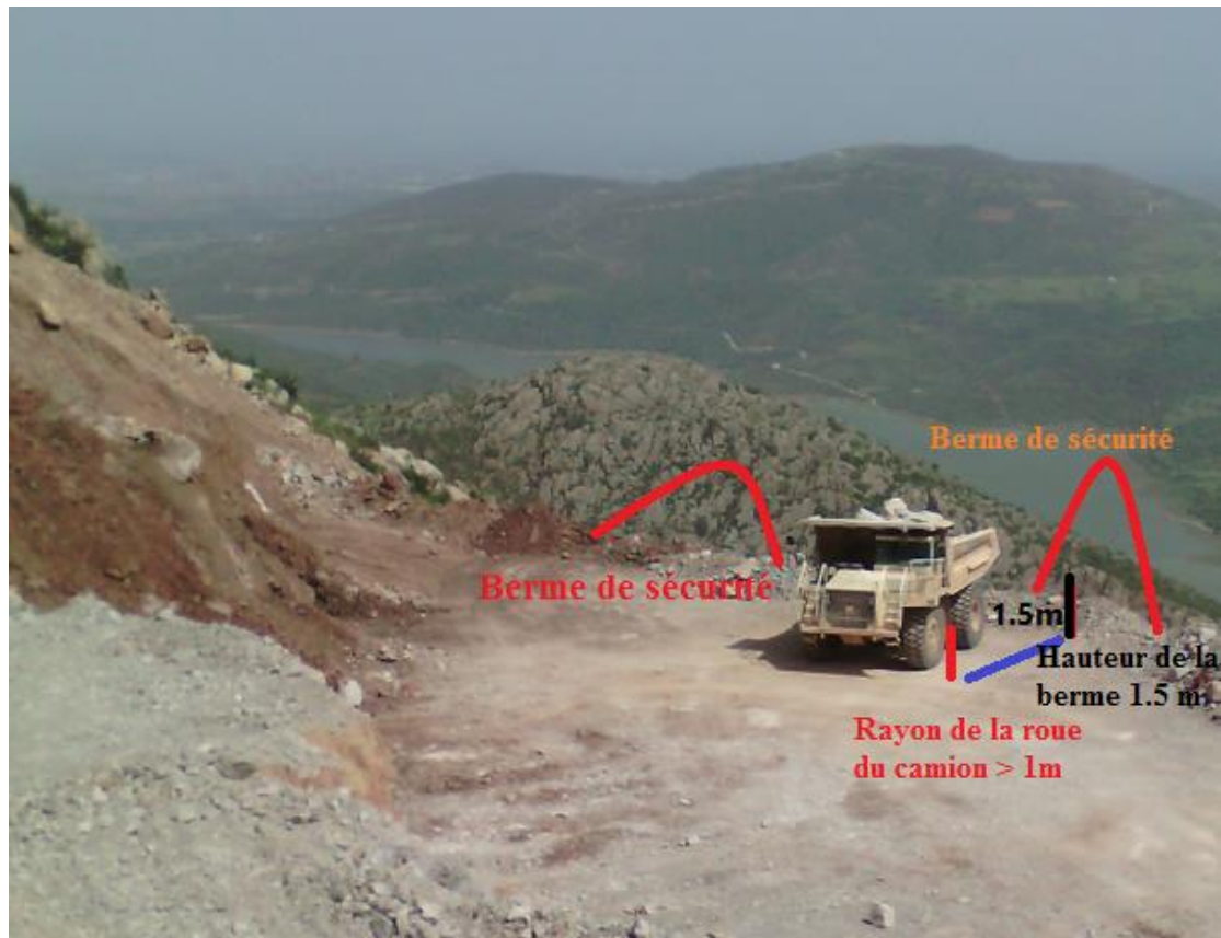
Figure II.4 : les merlons et les bermes de sécurité au niveau de la plateforme de culbutage d'IFRI.
