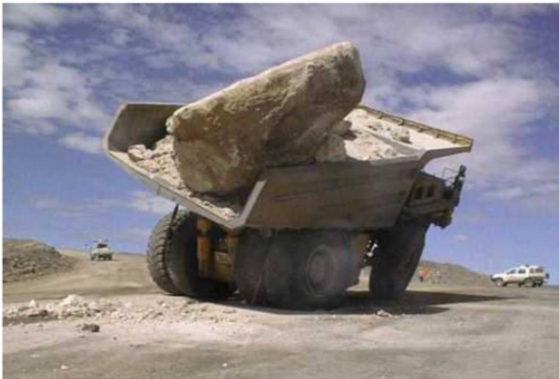
Figure II.1 : Le danger lié au chargement de gros blocs de roche minière (YAHYAOUÏ, 2016).
