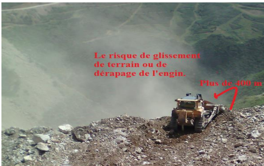
Figure II.7 : L'avancement dangereux du bulldozer utilisé pour le déblocage de la roche minière.
