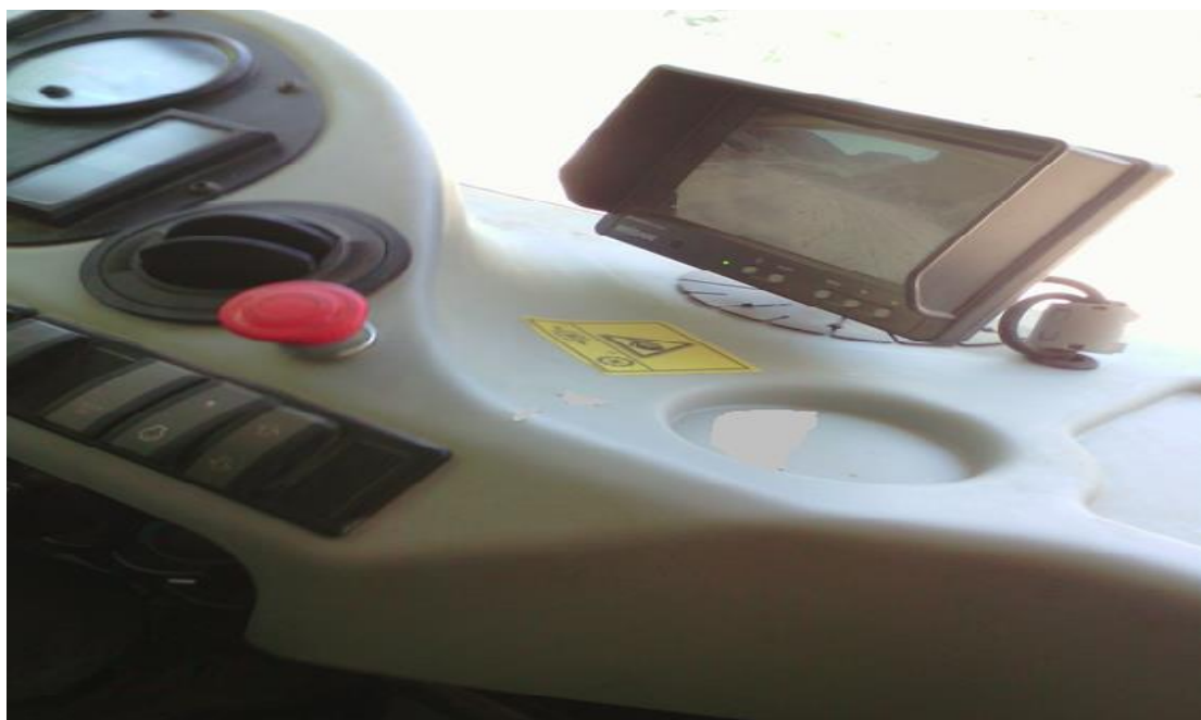
Figure II.8 : La caméra de visualisation dans la cabine de conduit du camion TREXE.
