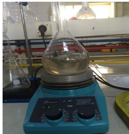
Fig.19 : Agitation magnétique de la solution S
