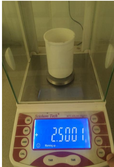
Fig.18 : Balance électronique sensible semi micro analytique a précision 0.001mg
