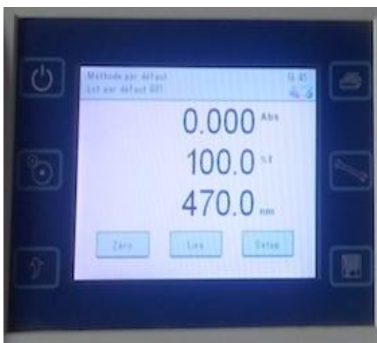
Fig.21 : Calibrage de l'appareil au zéro
