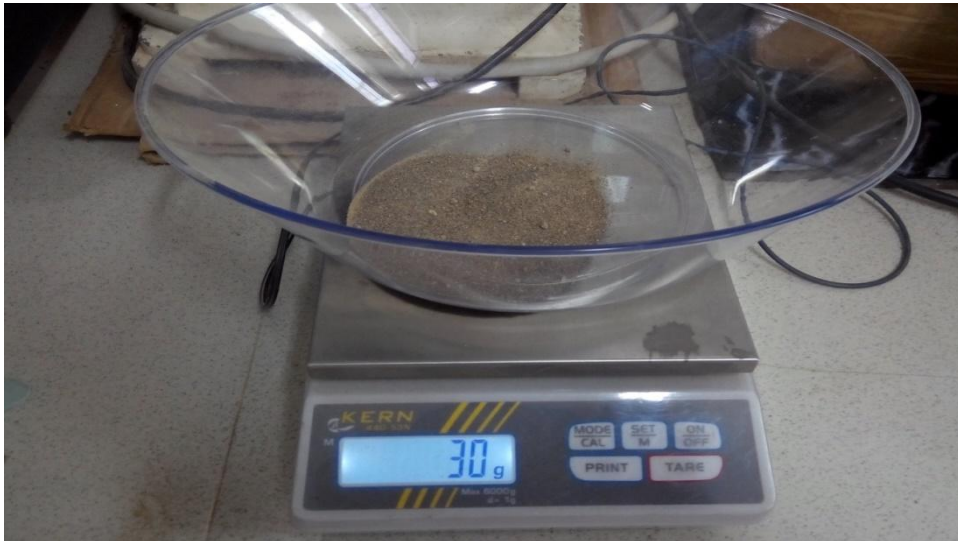
Fig.9 : Balance électronique de laboratoire à précision 0,001mg
