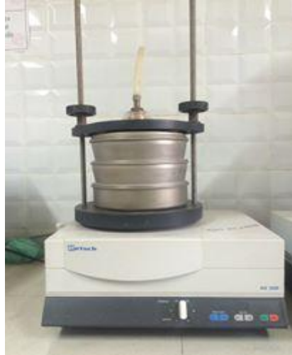
Fig.7 : Tamissage du produit débourbé à une granulométrie inférieure à 250 microns
