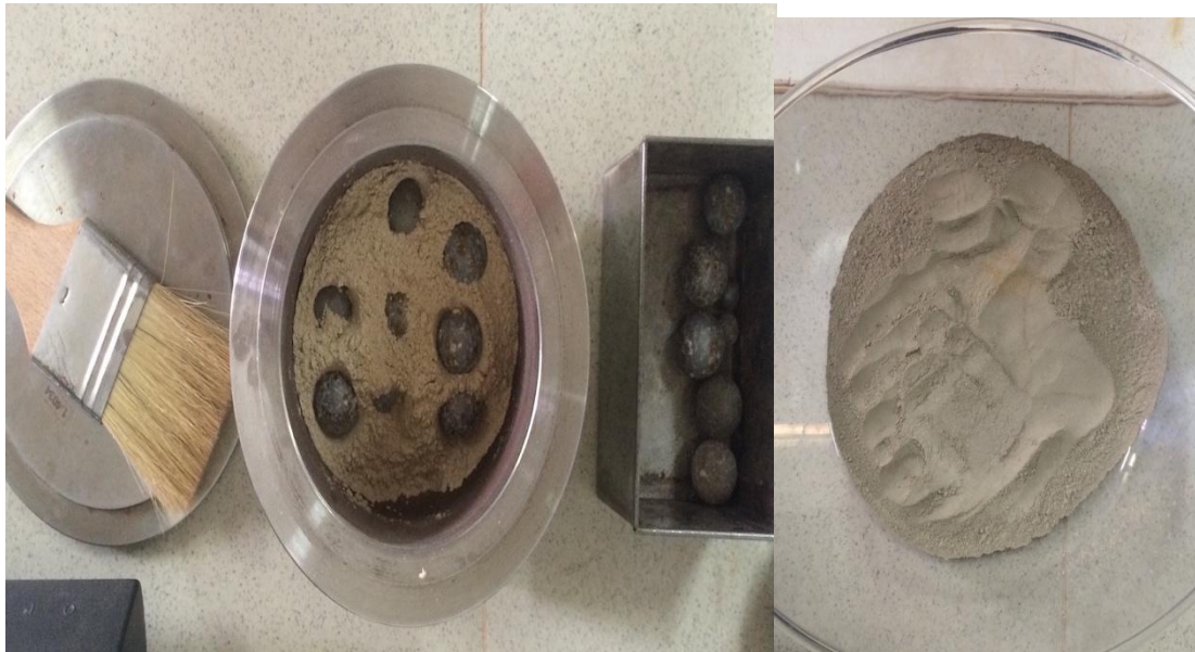
Fig.11 : Produit débourbé après 30 minutes de broyage
