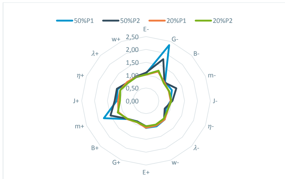
Figure 28. Robustesse du double PID par rapport au changement des paramètres du système dans le cas optimal
