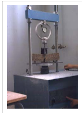
Fig. II.15 : Presse utilisée pour la mesure de la résistance à la flexion
