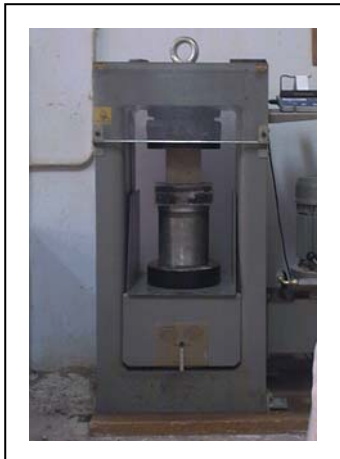
Fig. II.14 : Presse utilisée pour la mesure de la résistance à la compression
