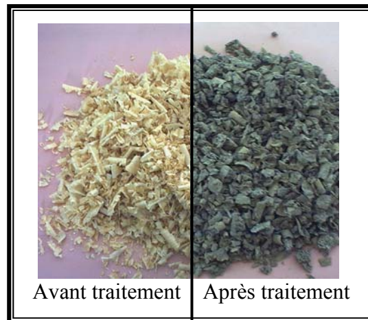
Fig. IV.33 : Aspect général des copeaux de bois avant et après traitement au ciment
