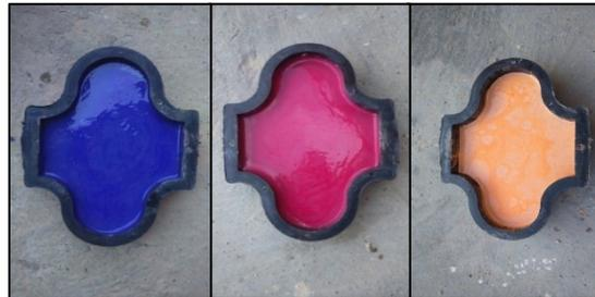
**Figure 5.6 : Séchage des pavés.**
