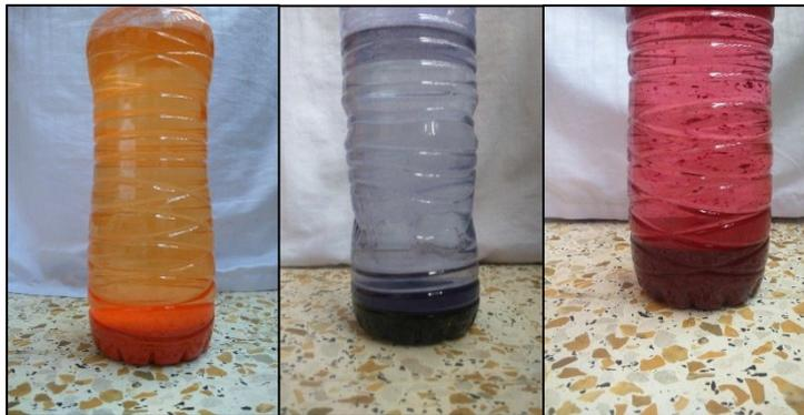
**Figure 5.2 : Décantation naturelle de la bentonite colorée.**
