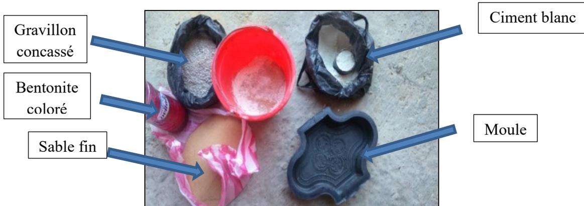
**Figure 5.1: Ingrédients pour la fabrication des pavés.**
