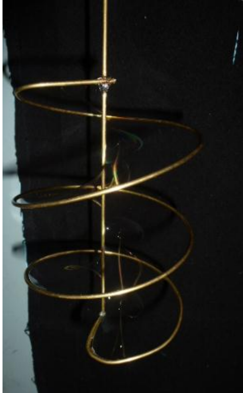
Figure III.6. Surface minimale (hélicoïde) créée par le film de savon dans une hélice.
