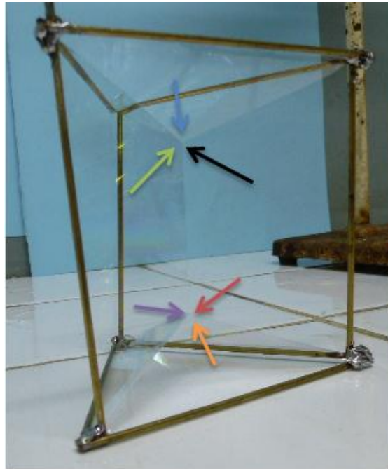
Figure III.2. Surface minimale formée par le film de savon dans un prisme triangulaire
