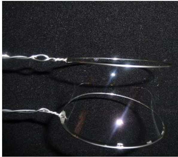
Figure III.5. Surface minimale (caténoïde) créée par le film de savon entre deux anneaux écartés.
