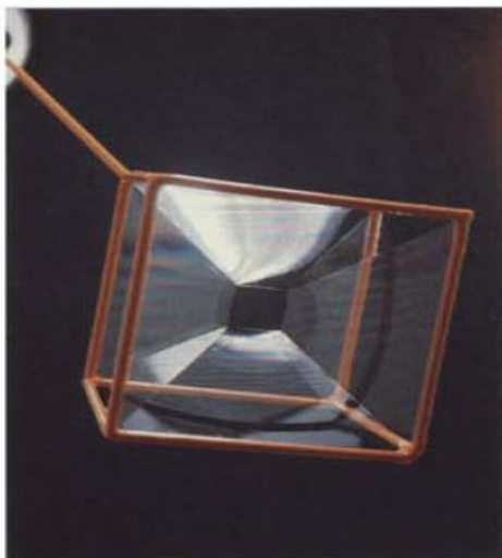
Figure II.14. Surface minimale d'un film de savon formé par les douze bords d'un cube [15]
