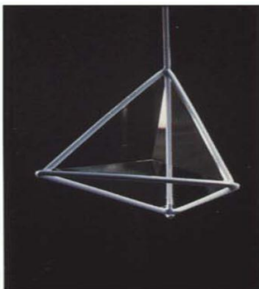
Figure II.10. Surface minimale formée par un film de savon contenu dans un cadre tétraédrique [15]
