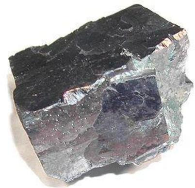
**Figure III.1 : Forme naturelle cristallisée du sulfure du plomb -Galène-**
