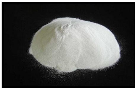
Figure I - 6 : Poudre calcinée de grande pureté d'alumine
