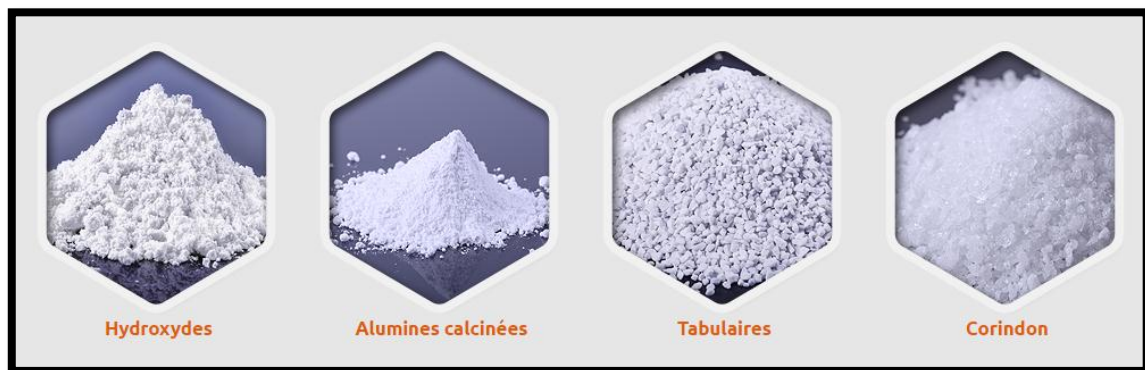
Figure I - 8 : Les différentes formes des alumines [33]
