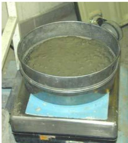
**Figure VI.8 : Essai de la stabilité au tamis**
