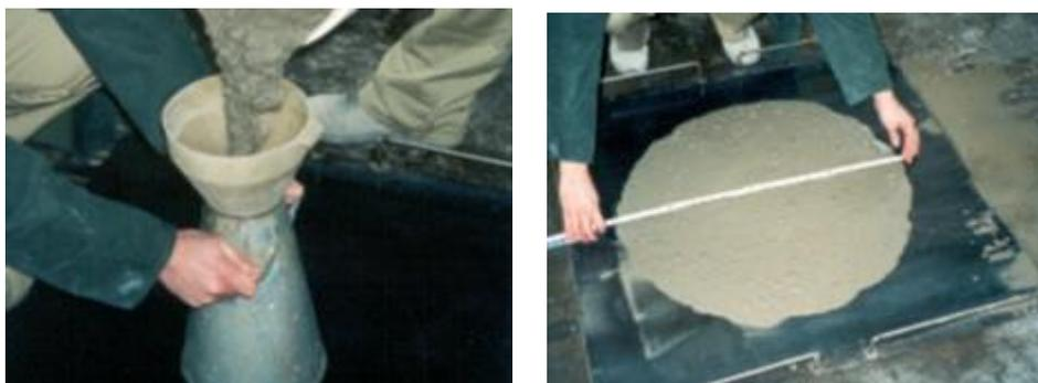
Figure VI.6 : Essai d'étalement
