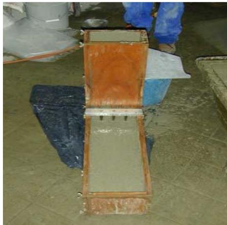
Figure VI.7 : Essai de la boîte en L
