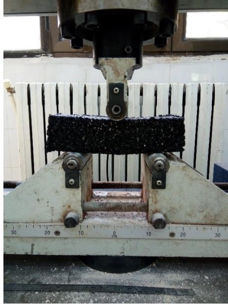
Figure.IV.7. Essai de traction par flexion sur le BB.
