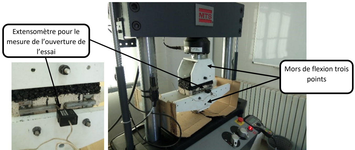
Figure V.4. : Système de fixation des éprouvettes pour l'essai de flexion trois points.
