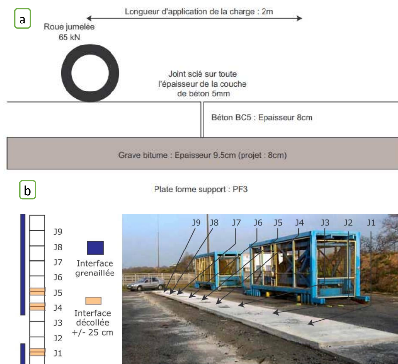
Figure I.6. (a) Géométrie de l'essai FABAC (b) vue générale sur la planche et les joints. [Pouteau, 2004]
