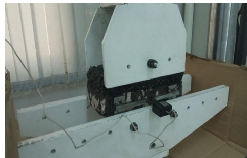
L'échantillon emplacer dans le mohr de flexion trois points
