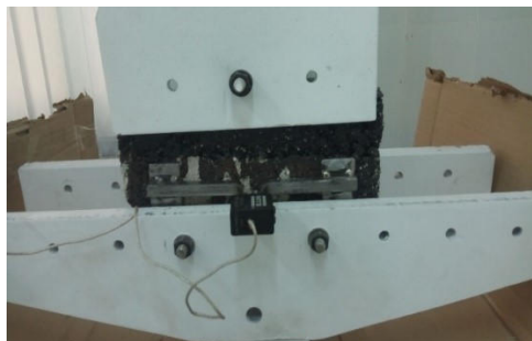
La fixation de l'extensomètre
