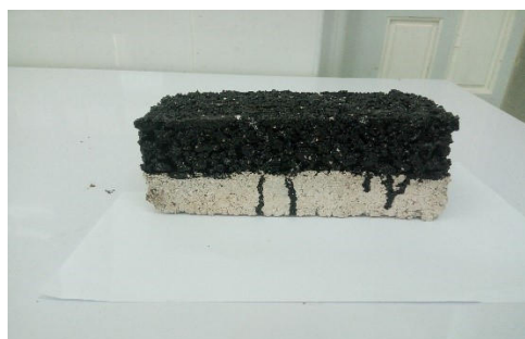
Echantillon après le coulage de BB
