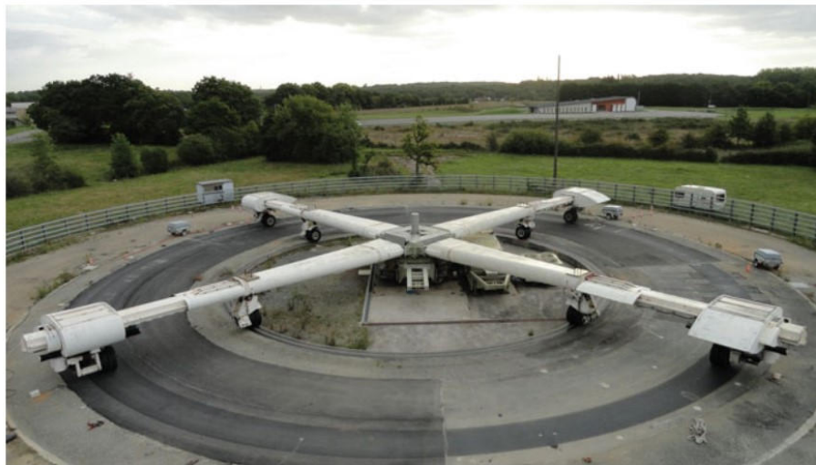
Figure I.4. Le manège de fatigue IFSTAAR [Hornych et al., 2008]
