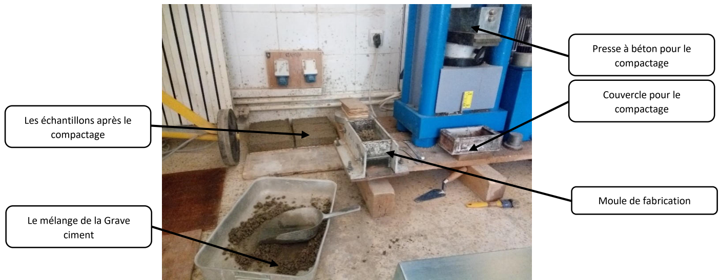
Figure III.14. Préparation de l'éprouvette
