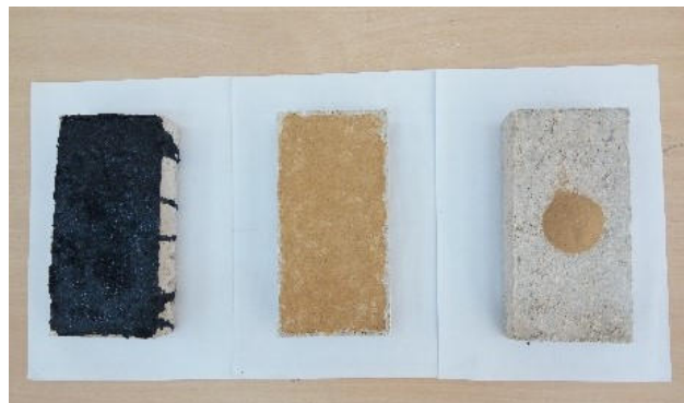
Figure V.1. Etapes de préparation de la couche d'interface, de droite à gauche. [Azzouzi et Kettab, 2018].
