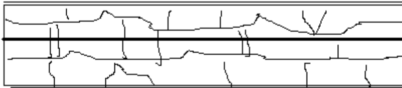
Figure 3.7 – Aspect de la surface de chaussée saharienne fissurée (Mersout, 1994)
