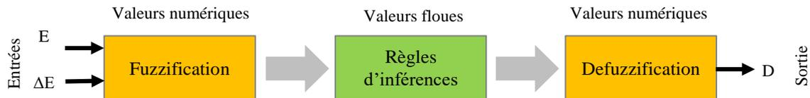
Figure.2.16 Structure de base du contrôleur MPPT à base logique floue.
