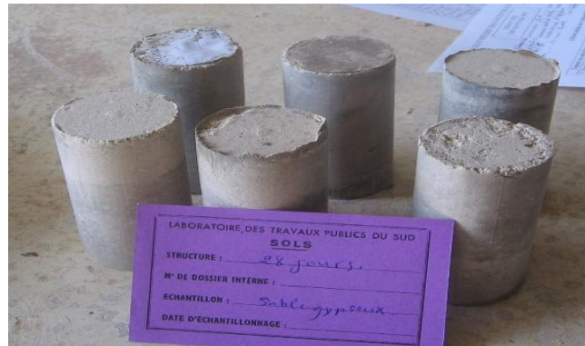
Photo 5 : conservation des éprouvettes à 28 jours
