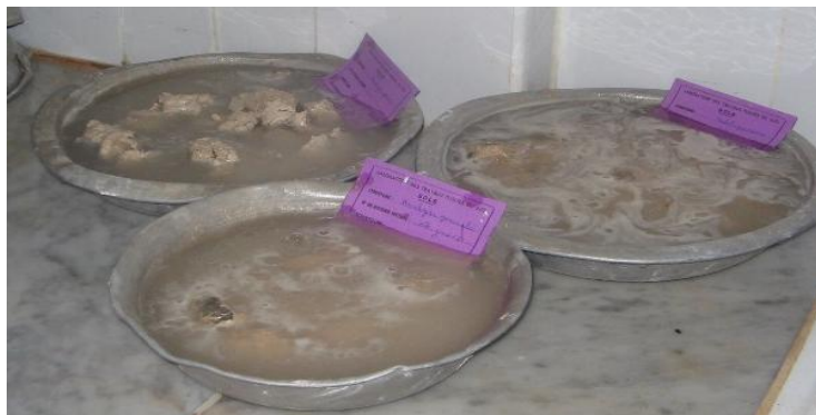
Photo 2 : Immersion du matériau avant l'essai granulométrique
