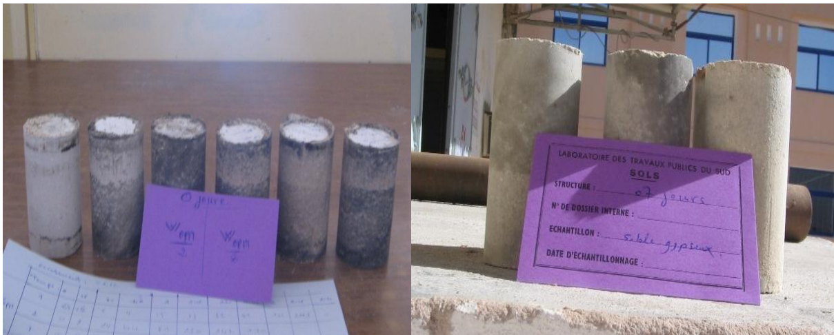
Photos 6 : Eprouvettes confectionnées à différente teneur en eau et exposées à l'air libre
