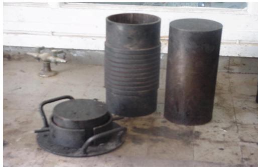
**Figure 3.4 :** Moule de l'essai Duriez dilaté
