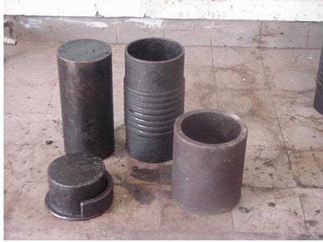
**Figure 3.3:** moule de l'essai Duriez simple
