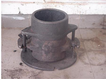
Figure 3.5: moule de l'essai MARSHALL
