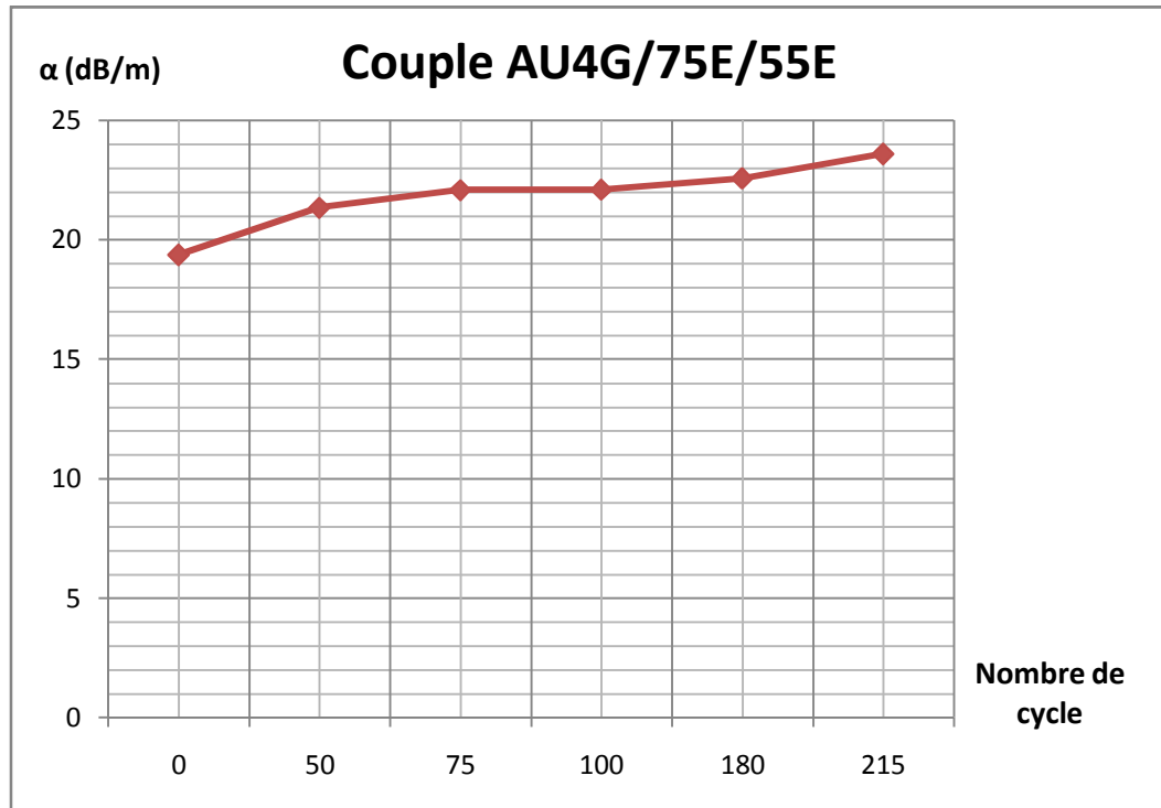
Figure V.16 : Evolution du coefficient d'atténuation en fonction du nombre de cycles thermique AU4G/75E/55E.
