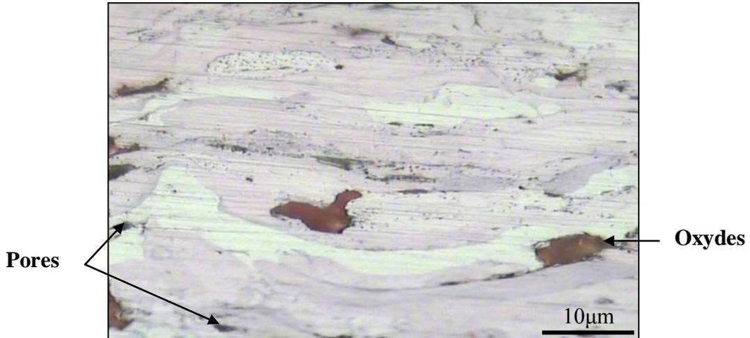
**Figure V.3.** Micrographie du dépôt de bronze phosphore réalisé par projection thermique ( $G=50$ ).
