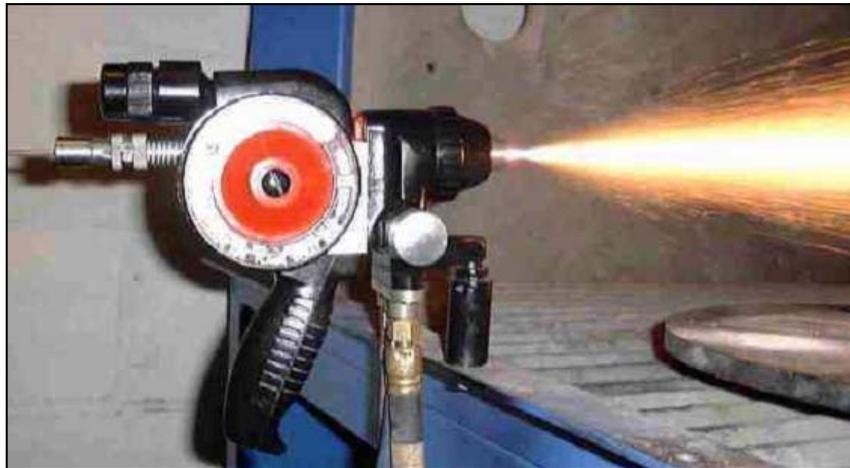
*Figure IV.1. Pistolet utilisé à la projection à l'arc électrique.*
