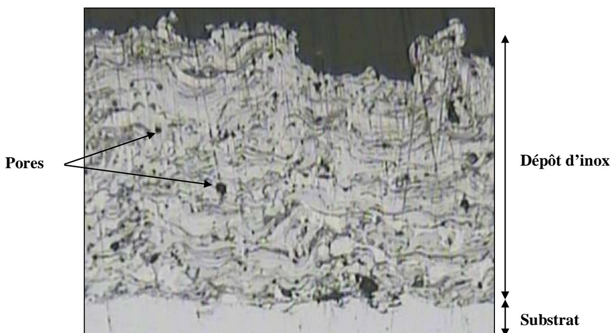
*Figure V.5. Micrographie du dépôt d'inox réalisé par projection thermique (G=10).*
