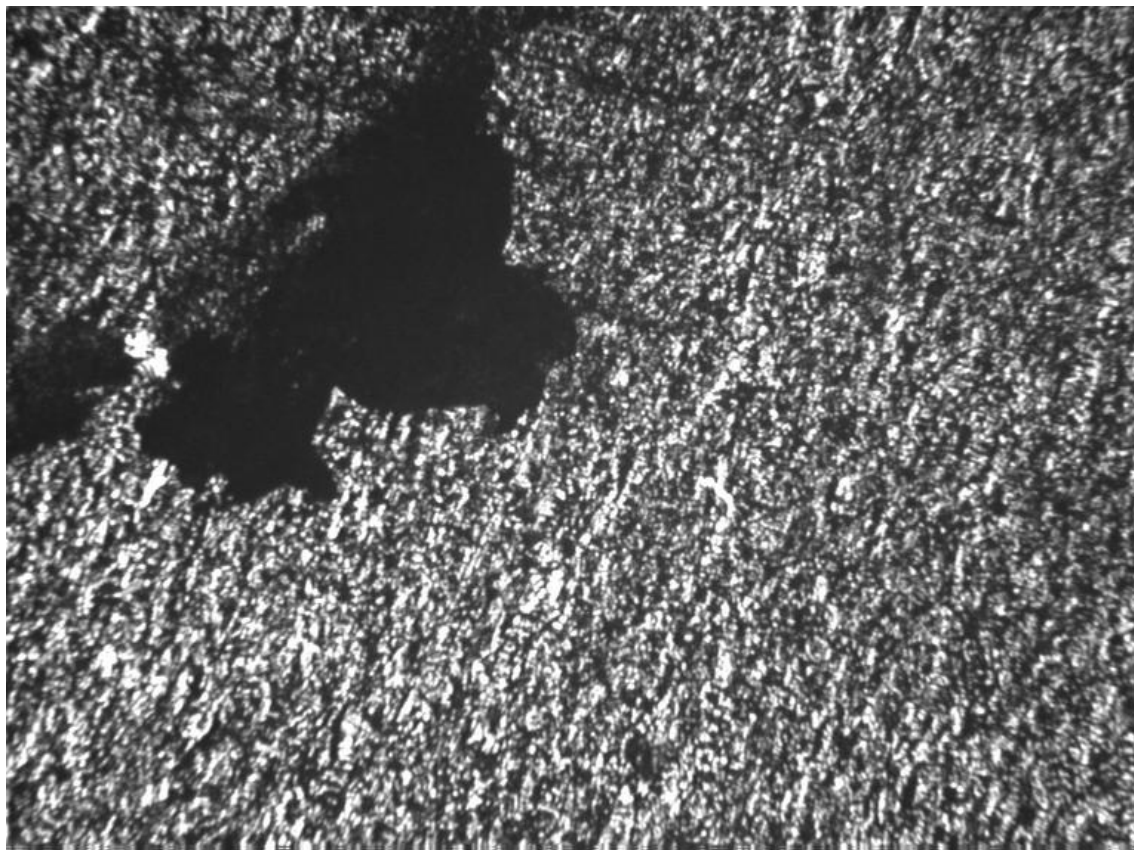
Figure. IV.28: Mise en évidence de la forme circulaire des piqûres après trente jours d'immersion dans un milieu \text{FeCl}_2 (0.5M).
