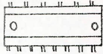
Reglette horizontale "face arrière" du répartiteur d'entrée
